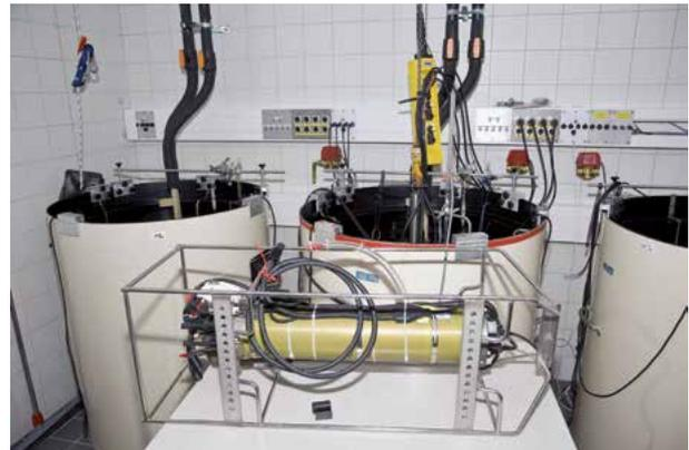
Im Kalibrierlabor steht Meerwasser mit unterschiedlichem Salzgehalt für die Prüfung der Messgeräte zur Verfügung
