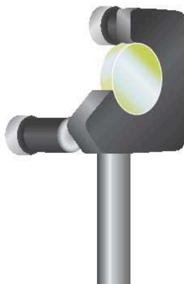
Laserspiegel in Justierhalterung
